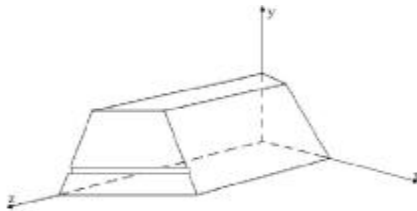
Рис. 1. Тіло ґрунтової греблі з водоводом
