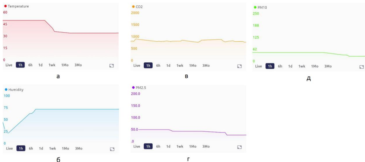
Рисунок 4. Графік зміни параметрів повітря: а) зміна вологості; б) зміна температури; в) аналіз вуглекислого газу; г) аналіз частинок пилу PM2.5; д) аналіз частинок пилу PM10
