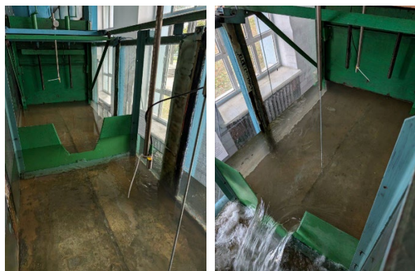
Рисунок 6 – Фото експериментальної установки для визначення ефекту підтоплення для водозливів, розташованих на Канівській ГЕС
