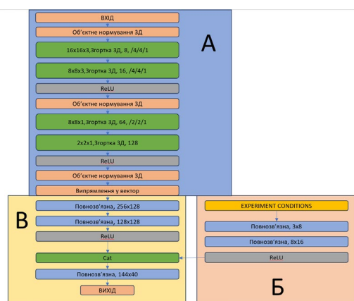
Рис. 1. Архітектура для прогнозування коефіцієнту пропускання діелектрику
