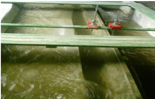
Рисунок 4. Дослідження водозбору протипаводкової ємності «Тершаків» на р. Бистриця у Львівській області
