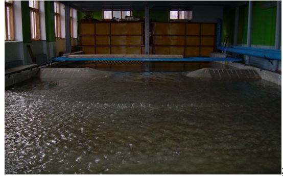
Рисунок 5. Модель бокового водозбору № 1 у вигляді потайного отвору на р. Тиса біля с. Вари в Закарпатській області (процес розмиву потайного отвору)
