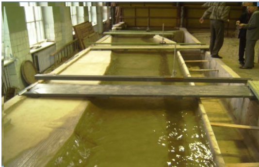
Рисунок 3. Лабораторне калібрування моделі ділянки р. Бистриця в створі будівництва водозбору протиपाводкової ємності «Тершаків» у Львівській області
